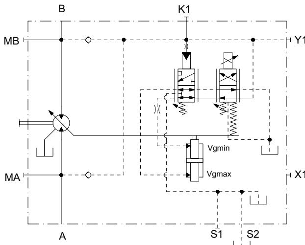
La relazione tra il senso di rotazione dell'albero del motore SH9V e la direzione del flusso è illustrata in figura
