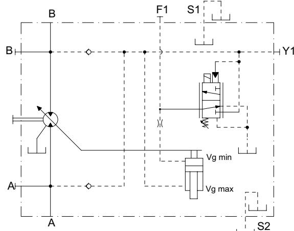
La relazione tra il senso di rotazione dell'albero del motore SH9V e la direzione del flusso è illustrata in figura
