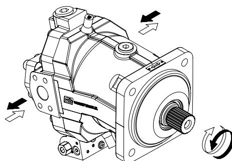
Il regolatore elettromagnetico a due posizioni permette di regolare la cilindrata del motore tra  $Vg_{max}$  e  $Vg_{min}$  intervenendo sull'alimentazione di un magnete ON/OFF. La mancanza della molla di retroazione consente di ottenere solo le due cilindrate estreme ( $Vg_{max}$  e  $Vg_{min}$ ).
