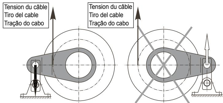
**Montage du treuil avec deux réducteurs avec bras de réaction (réducteur sans jeu intérieur) :**
