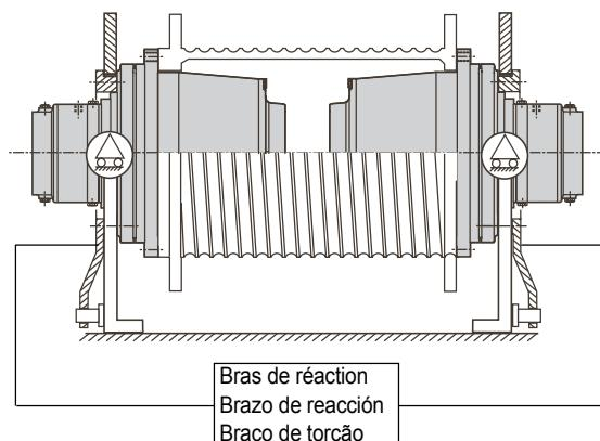
**Montage du treuil avec deux réducteurs sans bras de réaction (réducteur avec jeu intérieur) :**
