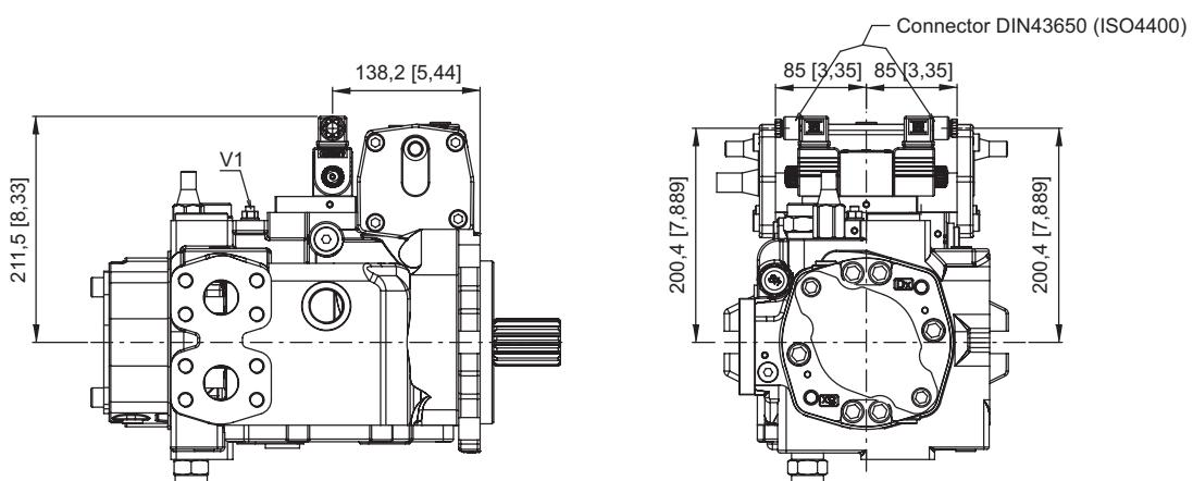
V1: strozzatore variabile / Adjustable throttle valve
