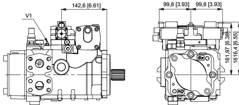
V1: strozzatore variabile / Adjustable throttle valve
