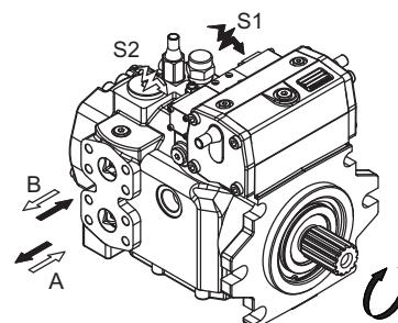
Alimentando uno dei due elettromagneti la pompa si porta alla cilindrata massima nel senso di mandata corrispondente al magnete eccitato. Togliendo l'alimentazione la pompa si porta in annullamento di portata.
