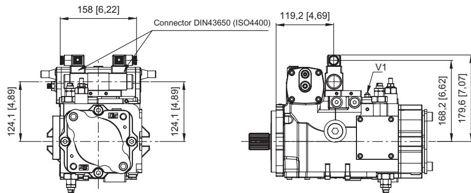
V1: strozzatore variabile / Adjustable throttle valve
