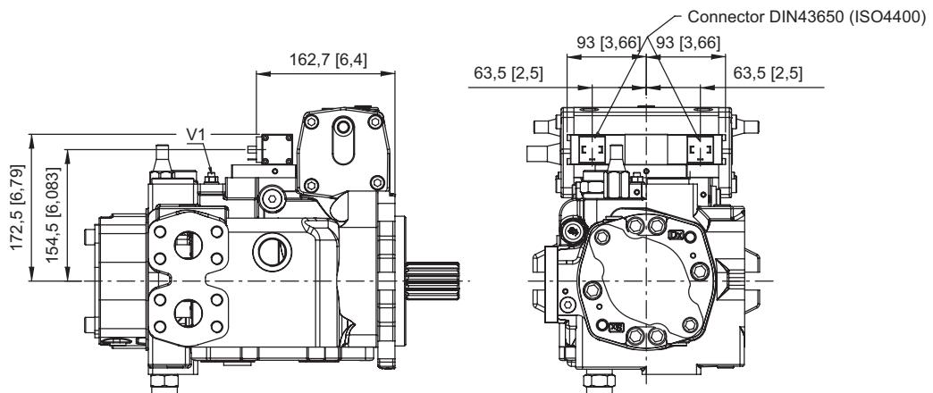
V1: strozzatore variabile / Adjustable throttle valve
