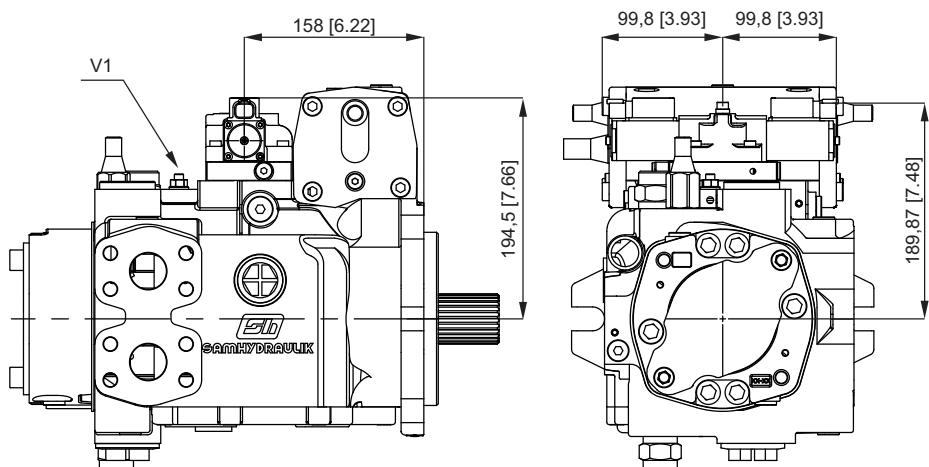
V1: strozzatore variabile / Adjustable throttle valve
