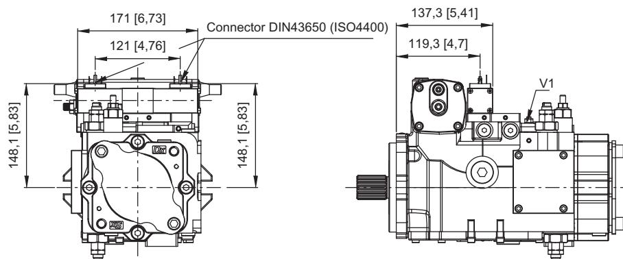
V1: strozzatore variabile / Adjustable throttle valve
