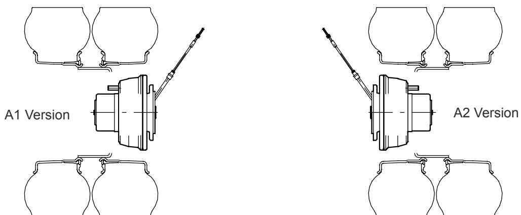
Cavo da ordinare con il riduttore ruota
